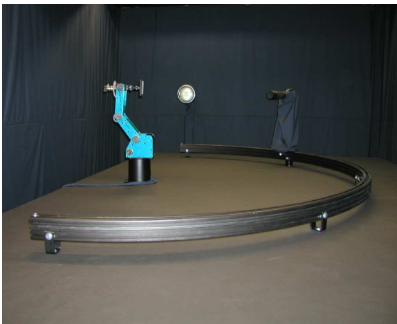
Obrázek 1: Robot pro měření BTF textur na Univerzitě v Bonnu. Vzorek materiálu se naklápí, světelný zdroj i kamera se pohybují, změří se 6561 kombinací.
